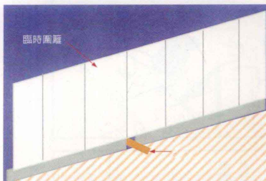
3 由工地圍籬孔隙鑽出的角材造成拌倒行人的現象。要防止這種情形的發生，至少要一天一次對工地周圍，以工地以外的第三者的立場進行檢察。
