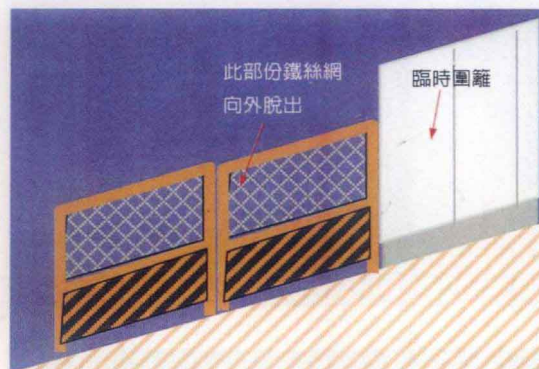
4 如上圖所示工地大門的鐵絲網有鐵絲朝外脫出而造成戳破路過行人外套的困擾。
