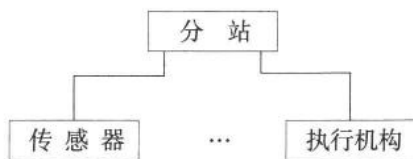
图 1.5 传感器及执行机构采用星形结构与分站连接
