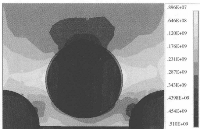
图 12 管孔应力强度分布(子模型,工况 3)
