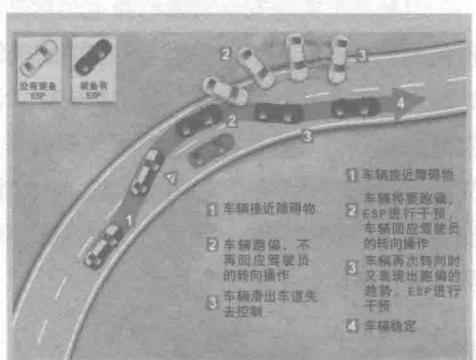
危急情况，装备和没有装备ESP的车辆的避让情况。ESP让车辆稳定地行驶在车道上，没有装备ESP，车辆侧滑。
