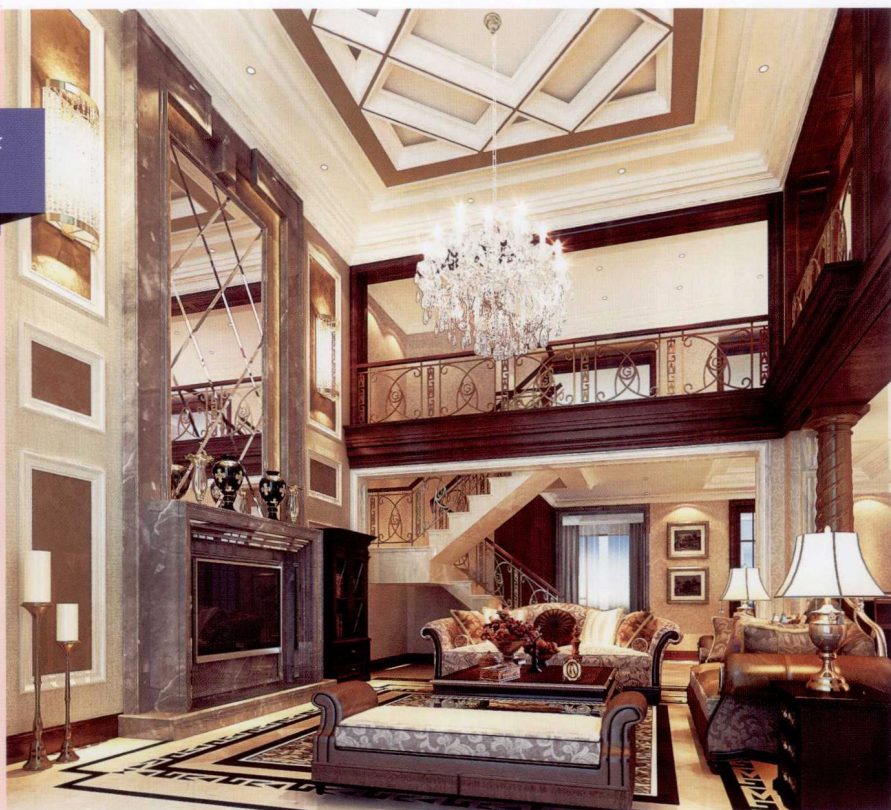
电视墙 [ 啡网纹大理石 + 银镜倒边 + 墙纸 + 木线条收口 ]
