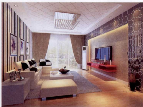
电视墙 [ 墙纸 + 木线条装饰造型刷白贴黑镜 ]
