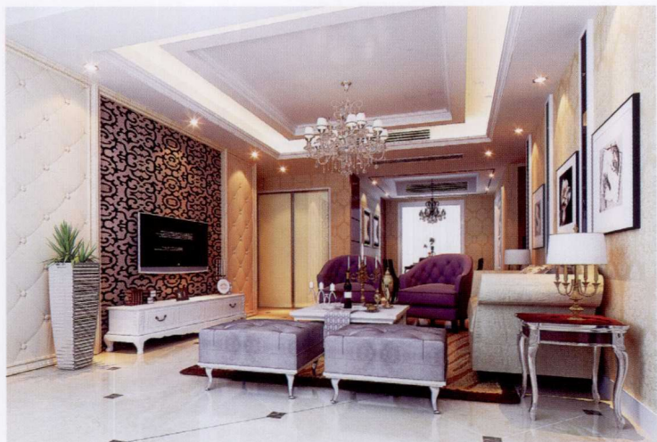
电视墙 [ 墙纸 + 布艺软包 + 大理石线条收口 ]
