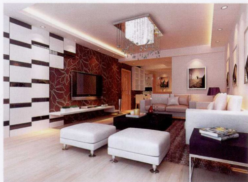
电视墙 [ 墙纸 + 石膏板造型 + 黑镜 ]
