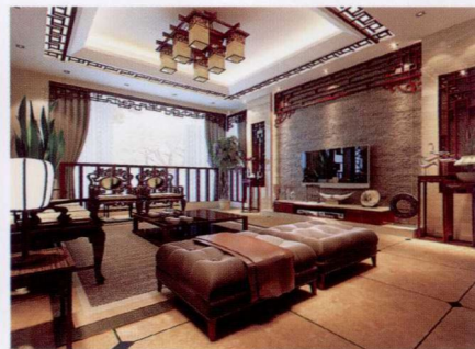
电视墙 [ 真石漆墙面喷涂 + 木花格 ]
