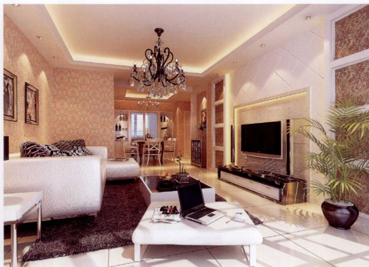
电视墙 [ 米黄大理石 + 石膏板造型拓缝 + 墙纸 + 石膏板造型 ]
