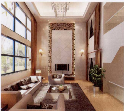
电视墙 [ 米黄大理石 + 墙纸 + 石膏板造型拓缝 ]
