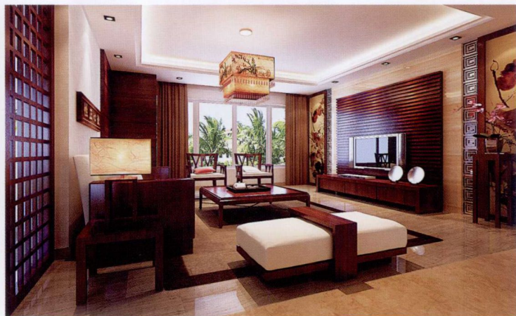
电视墙 [ 木线条装饰凹凸造型 + 回纹线条雕刻刷白贴银镜 ]
