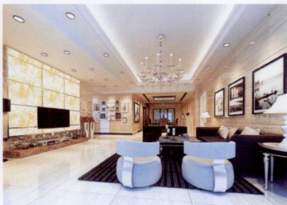
电视墙 [ 茶镜磨花 + 透光云石 + 不锈钢线条包边 ]
