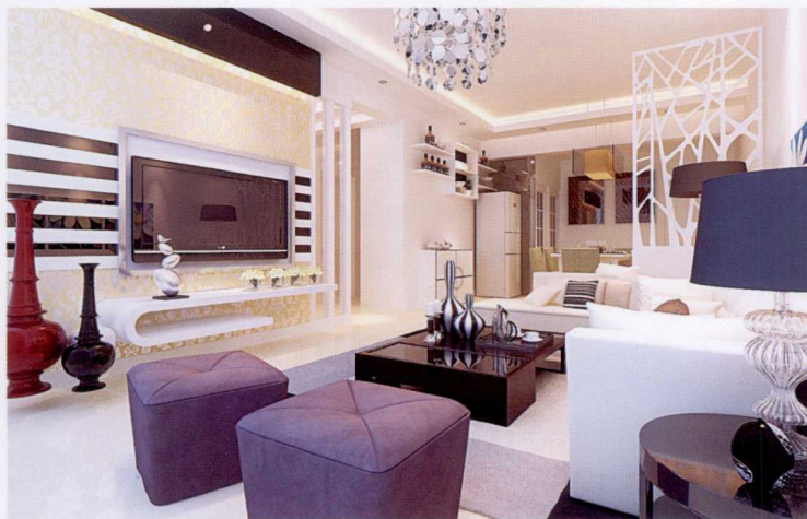
电视墙 [ 墙纸 + 烤漆玻璃 + 不锈钢线条装饰框 ]
