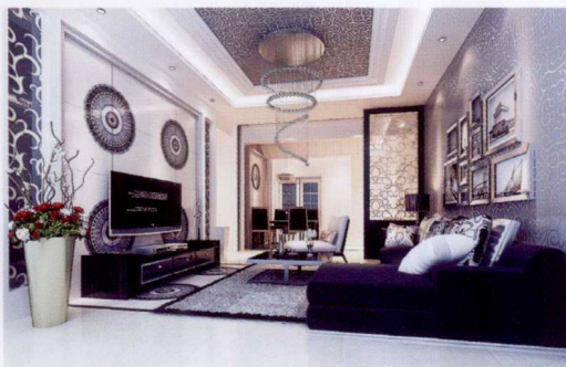
电视墙 [ 墙纸 + 木线条刷银漆收口 + 灰镜雕花 ]
