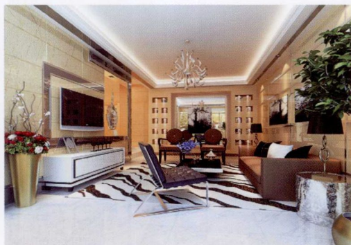
电视墙 [ 墙砖 + 灰镜 + 不锈钢线条包边 ]
