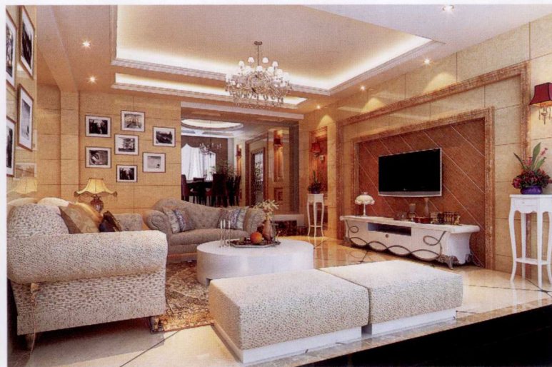
电视墙 [ 仿古砖斜铺 + 大理石线条收口 + 米黄大理石 ]
