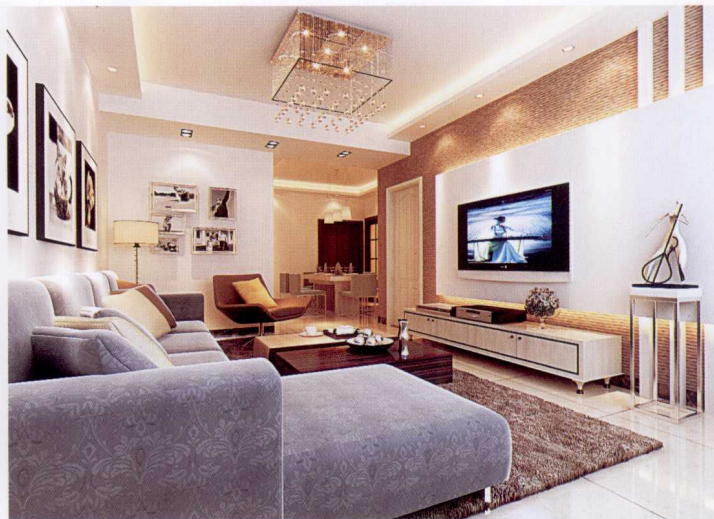
电视墙 [ 墙纸 + 石膏板造型 + 装饰方柱刷白 ]
