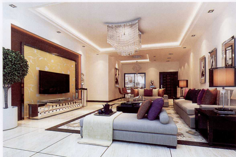
电视墙 [ 皮质硬包 + 墙纸 + 金属线条收口 ]
