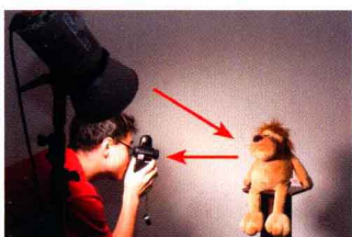
▲反射式测光的测光部件（观景镜头）需要面向被摄物。
