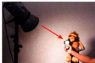
▲入射式测光的测光部件（白色半球）需要面向光源。
