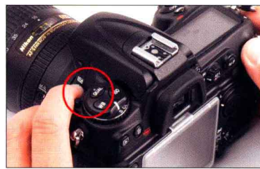
▲Nikon闪光灯系统的后帘幕闪光功能在机身设定。
