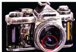
▲位于菲林反光镜的反光镜箱下的测光元件。
