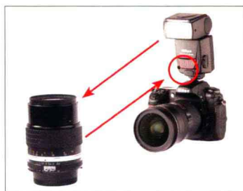
▲ 闪光在灯头射出后，被物体反射，一部分进入镜头被拍摄，另一部分进入“电眼”中，用来计算闪光输出量。
