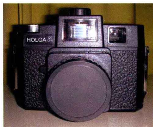
▲Holga Starter Kit全手动相机，顶部内置了固定焦距和固定输出功率的闪光灯。
