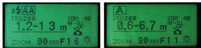
▲ Nikon SB-800和SB-900闪光灯的“电眼”A Mode拥有两个模式，分别是全自动，无须输入各项拍摄元素的AA模式(左图)和半自动，需要人手输入感光度、光圈和焦距的A模式(右图)。
