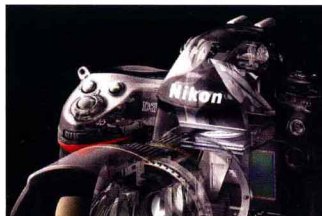
▲位于DSLR Nikon D3机顶的五棱镜后方的测光系统，就是TTL闪光测光的重要核心。
