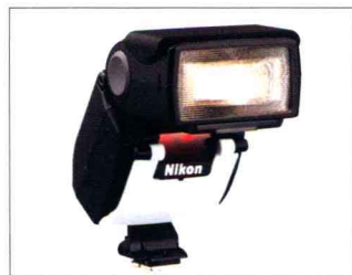
▲ Nikon曾经推出一支拥有D-TTL功能的特殊用途闪光灯SB-50DX,它内置了一块柔光片,可以拉下遮挡相机的内置闪光灯,令其光质变得柔和。在SB-50DX的灯头上翘起做出天花板反射时,内置闪光灯能同时发光,成为补光,变成一套效果出色的子母灯。
