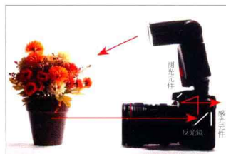
▲预闪闪光在射出后被对象反射，穿过镜头，进入相机，由反光板反射，最后到达机顶的测光模块。整个过程会在按下快门掣至快门正式开启前的一刹那完成。
