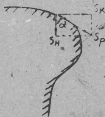
图 4 仿型加工中进給速度的合成
