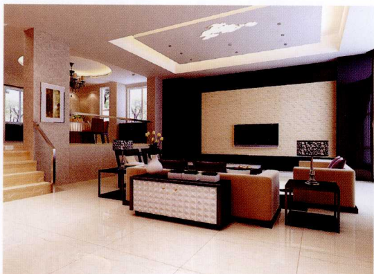
顶面 [石膏板造型 + 灯带 + 石膏浮雕]
