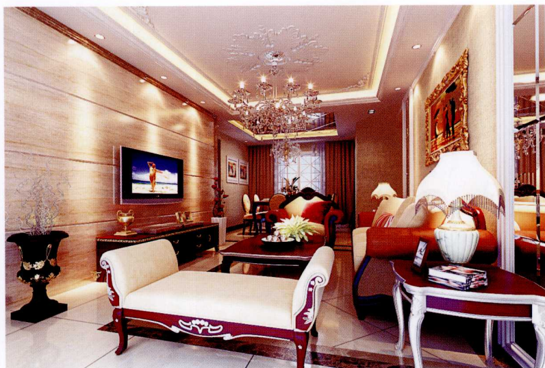
顶面 [ 石膏板造型 + 灯带 + 石膏浮雕 ]
