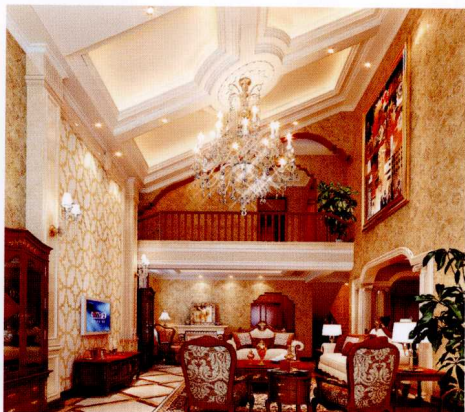
顶面 [石膏板造型 + 灯带 + 石膏浮雕]
