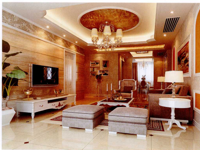
顶面 [石膏板造型 + 灯带 + 金箔墙纸]
