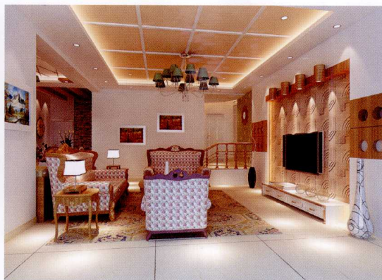
顶面 [ 彩色墙面乳胶漆 + 木线条打方格刷白 ]
