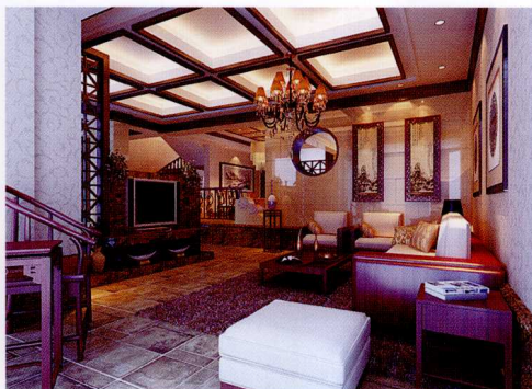
顶面 [ 石膏板造型 + 灯带 + 木线条装饰框 ]
