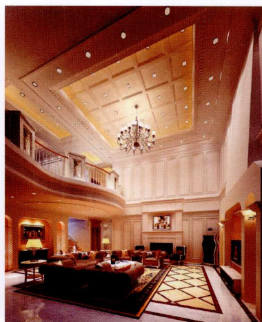
顶面 [石膏板造型 + 木线条打方格刷白]
