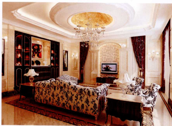
顶面 [石膏板造型 + 灯带 + 金箔墙纸]
