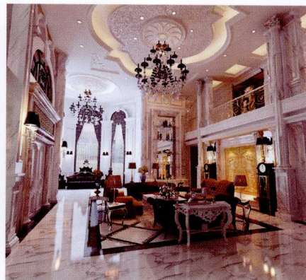
顶面 [石膏板造型 + 灯带 + 石膏浮雕]
