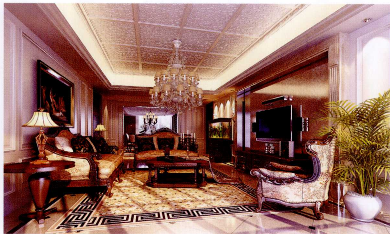
顶面 [ 石膏板造型 + 灯带 + 石膏浮雕 + 木线条打方框刷白 ]
