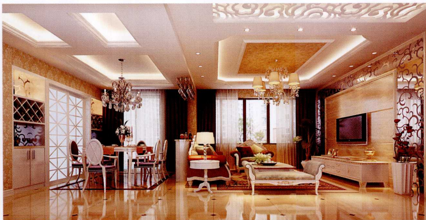
顶面 [ 石膏板造型 + 灯带 + 金箔墙纸 + 密度板雕花刷白 ]
