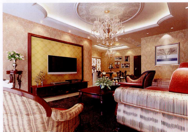
顶面 [ 石膏板造型 + 墙纸 + 木线条刷白 ]
