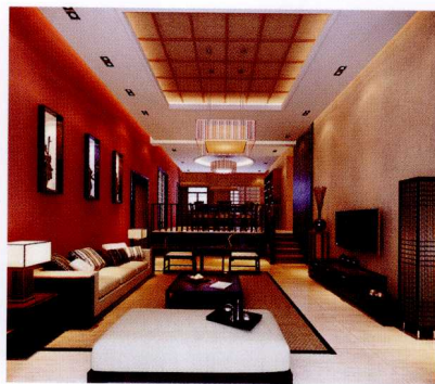
顶面 [石膏板造型 + 墙纸 + 木线条打方格]
