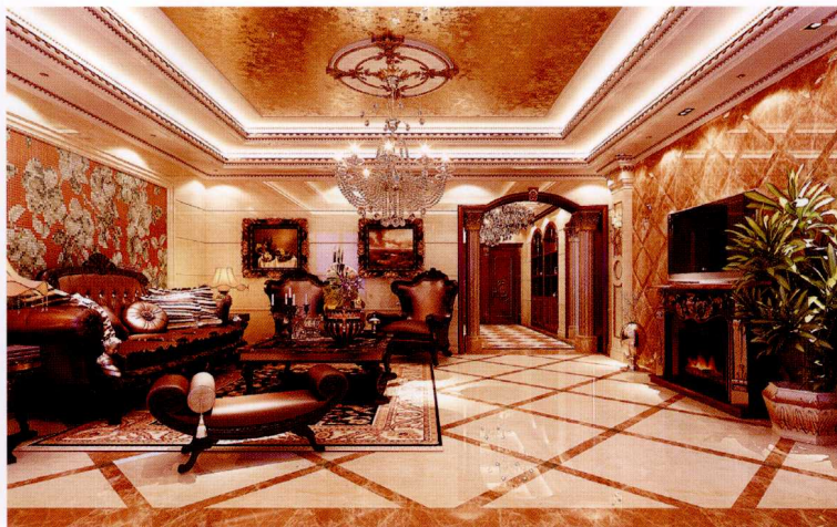
顶面 [ 石膏板造型 + 灯带 + 金箔墙纸 + 石膏线条描金 ]
