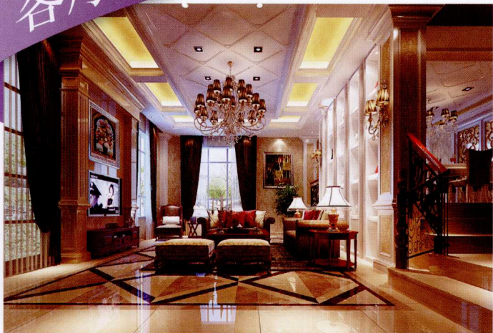
顶面 [ 石膏板造型 + 灯带 + 金箔墙纸 + 木网格刷白 ]
