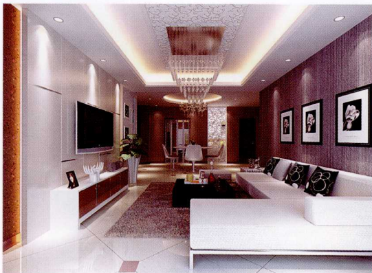
顶面 [ 石膏板造型 + 灯带 + 石膏浮雕 ]
