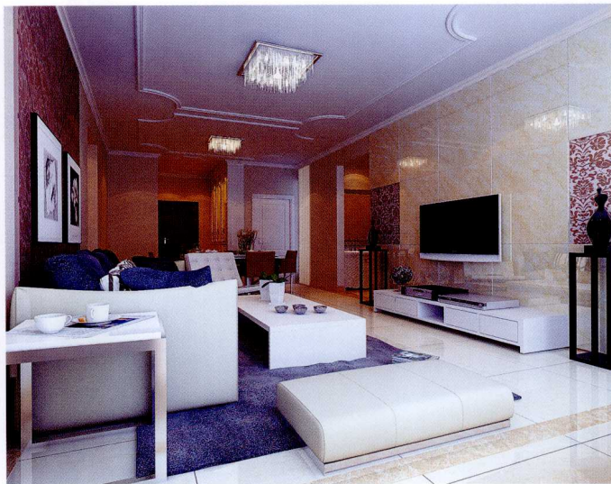
顶面 [ 石膏顶角线 + 木线条装饰造型刷白 ]
