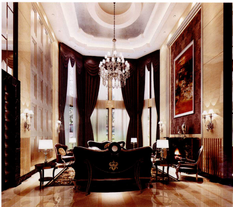
顶面 [ 石膏板造型 + 灯带 + 银箔墙纸 ]
