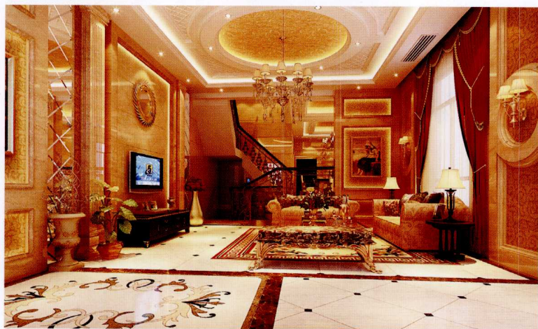
顶面 [石膏板造型 + 灯带 + 金箔墙纸 + 木网格刷白]
