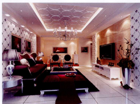
顶面 [石膏板造型 + 灯带 + 石膏圈式浮雕]
