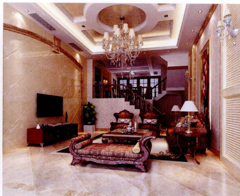
顶面 [石膏板造型 + 灯带 + 银箔墙纸]
