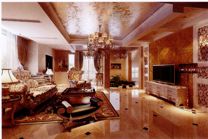
顶面 [ 石膏板装饰梁 + 石膏浮雕 + 银箔墙纸 ]
