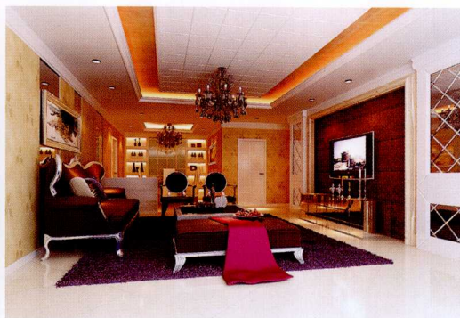
顶面 [ 石膏板造型拓缝 + 灯带 + 金箔墙纸 ]
