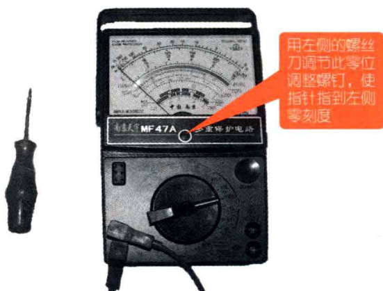
图1-12 指针式万用表调零
