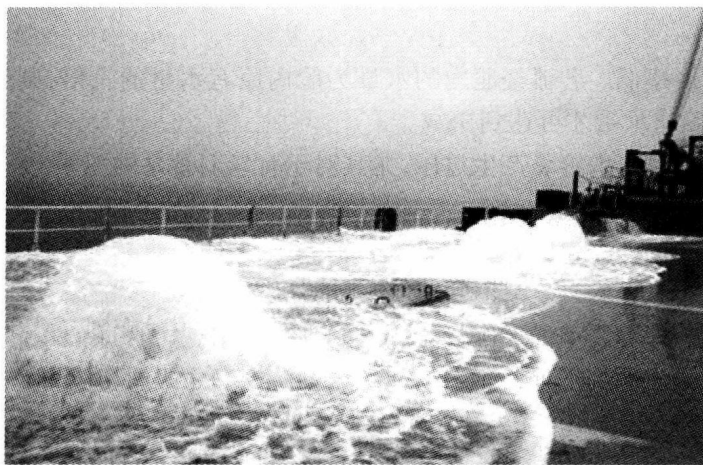
图 1.9 一艘正在采用溢流法进行压载水置换的船舶 [29]
