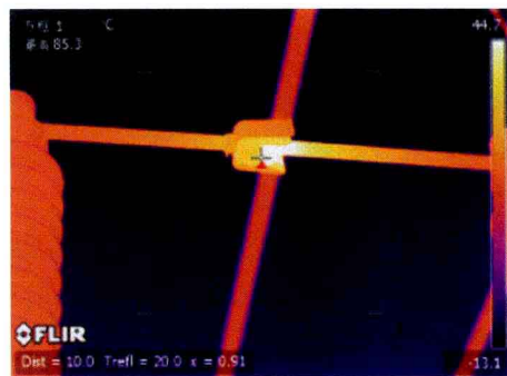
图 1-7 辐射率定在 0.91 时的 红外热像（温度 85.3℃）
