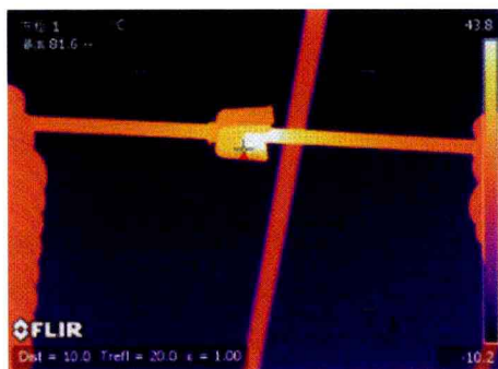
图 1-6 辐射率定在 1 时的 红外热像（温度 81.6℃）
