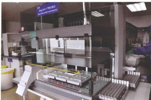
彩图 12-1 自动化移液站 适用于新鲜血液、DNA、蛋白质、代谢产物等液性样本的分装，有较快的分装速度
