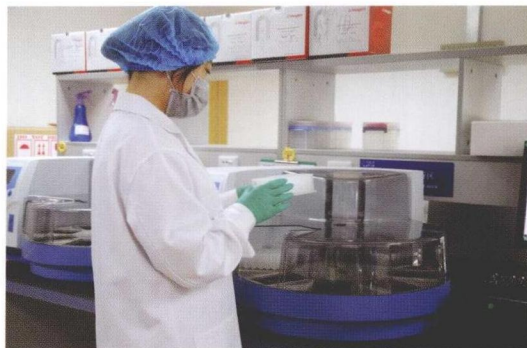
彩图 12-2 全自动磁珠提取系统 可提取血液、组织、病毒等核酸，通量较高
