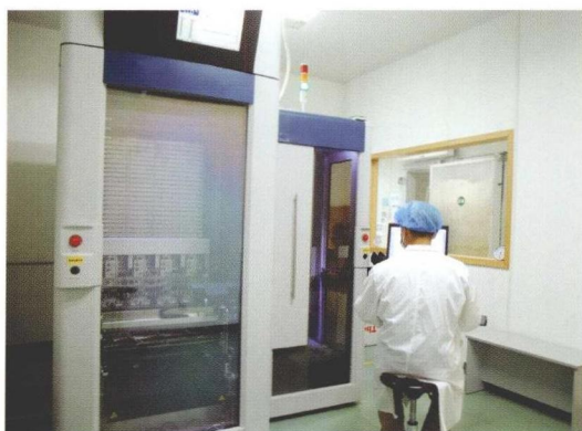
彩图 12-3 自动化样品存储管理系统 可保存数 10 万份 2D 标记的冻存管，可以用于血液、尿液甚至组织的存储。设备高度自动化，能根据指令，在不影响其他样本的情况下挑选单个样本，充分保证样本的保存质量
