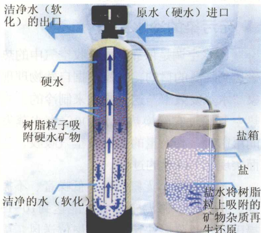
软化水设备的工作原理示意图
