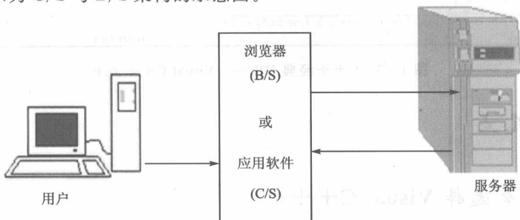
图 1-2 C/S 与 B/S 架构示意图
