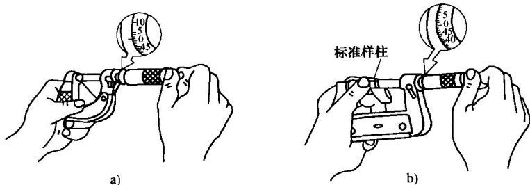
图 1-6 外径千分尺零位的检查
