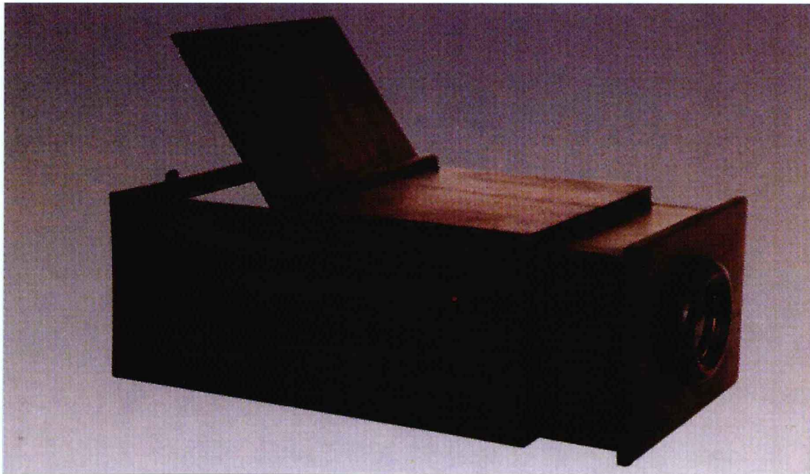
图6_带有 45^\circ 反光镜和磨砂玻璃的暗箱
