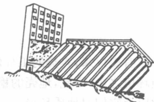
图 1-2 加拿大特朗斯康谷仓地基破坏状况示意图
