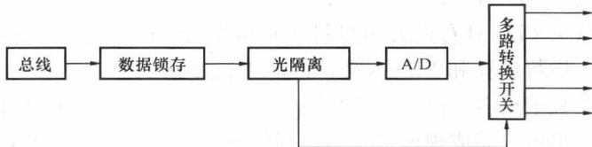
图 1-11 模拟量输出电路原理框图
