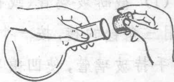
图 3 把橡皮管套在玻璃管上的方法
