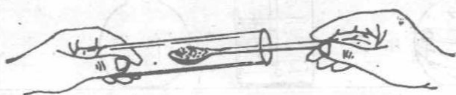
图6 向试管里加入粉末状药品
