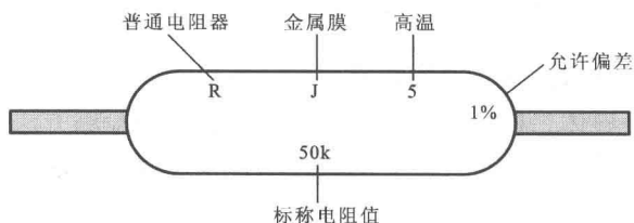
图 1-2 采用直标法的电阻器
