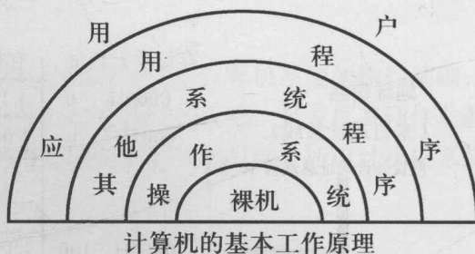
图 1-8 用户、软件、硬件之间的关系
