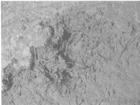
图7 莫高窟第351窟地仗泥层结构和麦草
