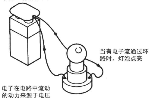
图1.3 当环路完整的时候，电池使电子沿环路流动。如果没有连接好（如图1.4所示），没有电子流动，电池仍旧有能力使得电子流动
