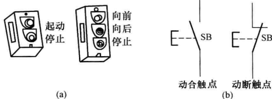
图 1-11 控制按钮外形图及符号
