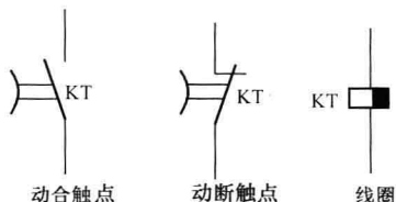
图 1-10 断电延时继电器的符号
