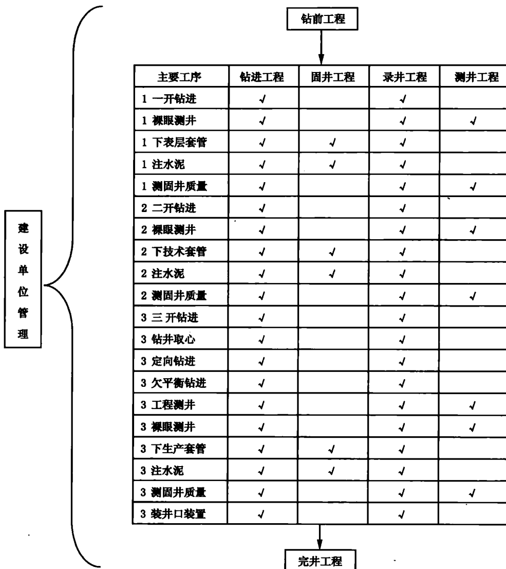
图 1-12 钻井工程内容和主要工艺流程 标“√”表示此工程内容与该工序相关
