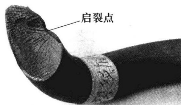
图1-9 断裂弹条的宏观断口照片
