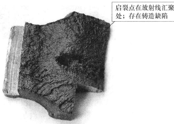
图 1-13 铸钢件断口形貌
