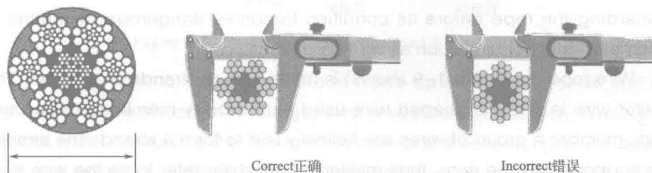
Figure1-10 Wire Rope Diameter Measurement Method ( 钢丝绳直径测量方法 )
