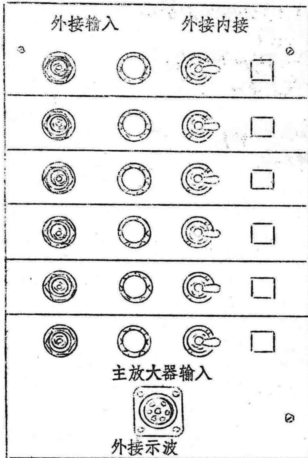
外接示波器插座，可以再接一只示波器。则这样可以多处监视生理电量变化曲线。用于手术时，手术台旁边可以只放一只示波器监视及一只遥控箱。本机放在手术室外面，机器操作人员可以不必用隔离措施。这样在手术台上既可以用示波器来监护手术病员又可以在必要时用遥控箱来控制记录，走纸等。选择开关投向“内”时，是将前置大器输出信号输给记录器及示波器，投向“外”时，示波器记录器信号来自磁带记录器放叠加仪输出端，其幅度可以用面板上的电位器来
