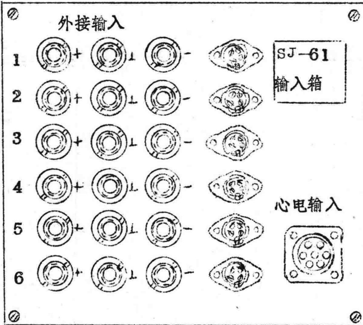
前置放大器要通过电极或传感器由患者的被测部位取得信号。六只前置放大器同时使用时往往要有很多连接线与患者相连。这样不但连续线很乱，而且连接线不易屏蔽，所以连接线只能做得很短，机器只能靠得患者很近，因此在手术室中使用，就很不方便。“输入箱”就用来解决这个问题。“输入箱”与前置放大器用一束很长总屏蔽线连接，“输入箱”就放在患者的旁边，用很短的连接线与患者相连。机器可以远离患者，便于实验室、手术室使用。
