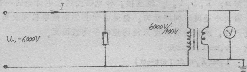
图 1—13 用电压互感器测量交流高电压
