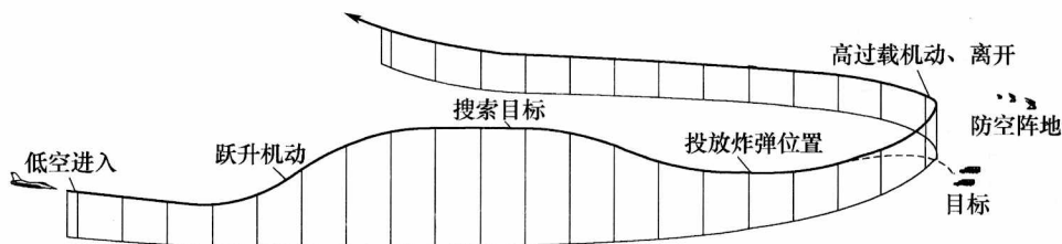
图 1-1 典型作战飞机投掷近距离武器的末段飞行剖面
