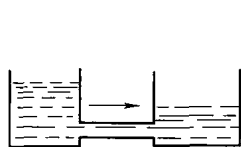
(a) 两水箱存在水位差，水从高水位流向低水位
