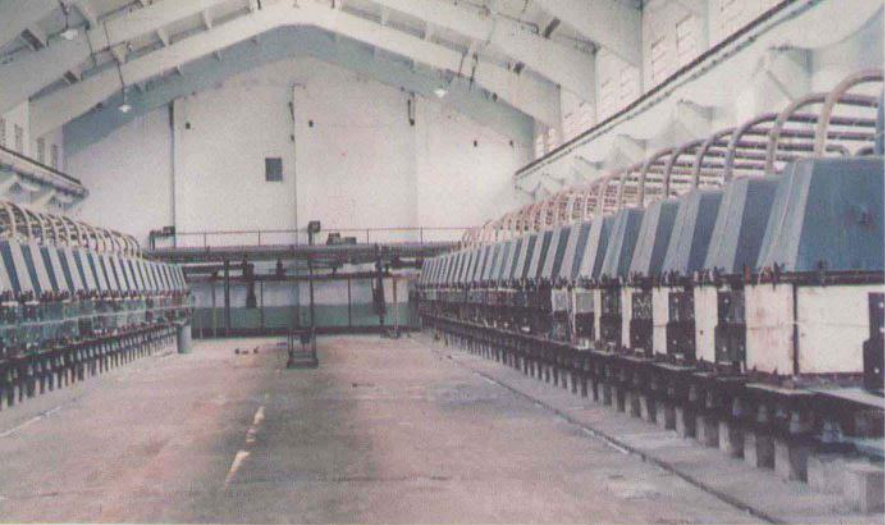
24. 无锡化工集团公司万吨 金属阳极隔膜电解装置
