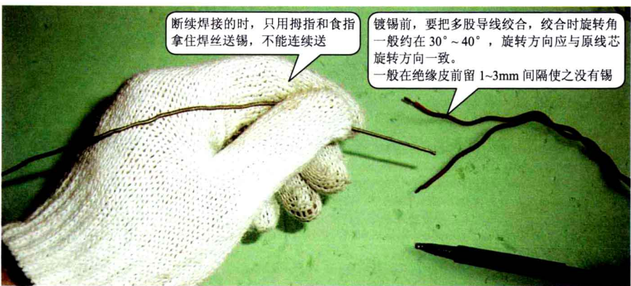
断续焊锡时焊锡丝的拿法
