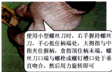
小型螺丝刀的使用方法
