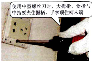
中型螺丝刀的使用方法
