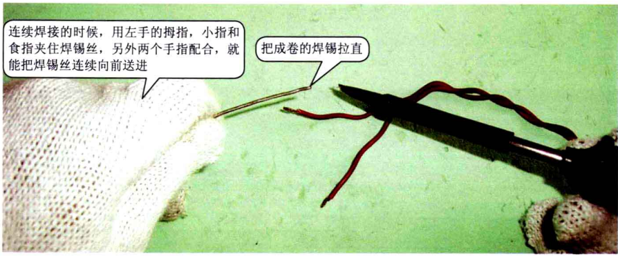
连续焊锡时焊锡丝的拿法
