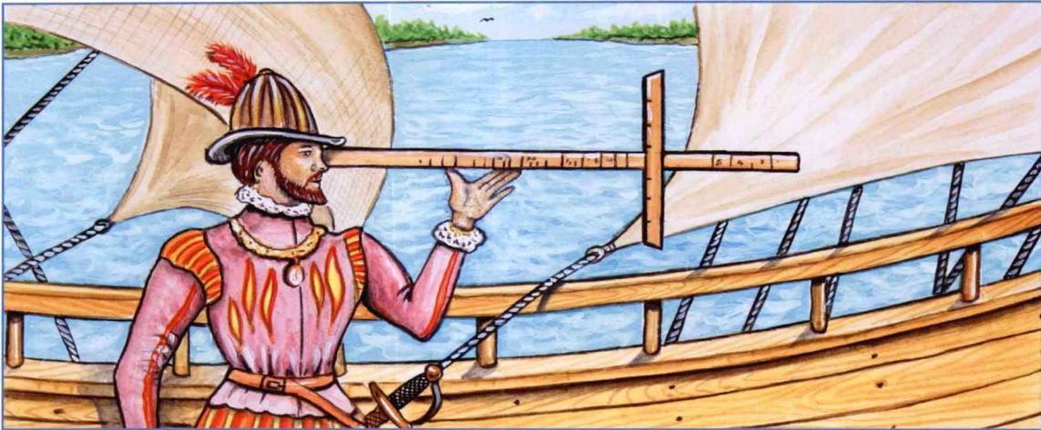
海员将标杆举至齐眉高度，调整移动短杆的位置，直到同时看到被观测星体和地平线为止，然后记录短杆在长标杆上位置对应的刻度。这时所读出的数字就是被观测星体的高度。
