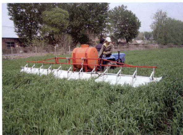
图20 防飘喷杆喷雾机在麦田喷雾作业
