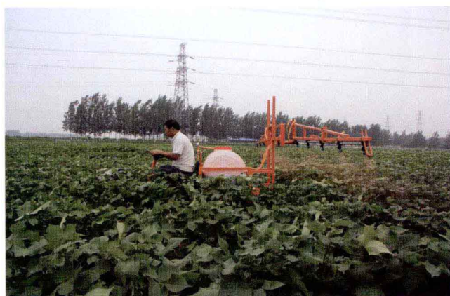
图14 轻型自走式喷杆喷雾作业（河南）
