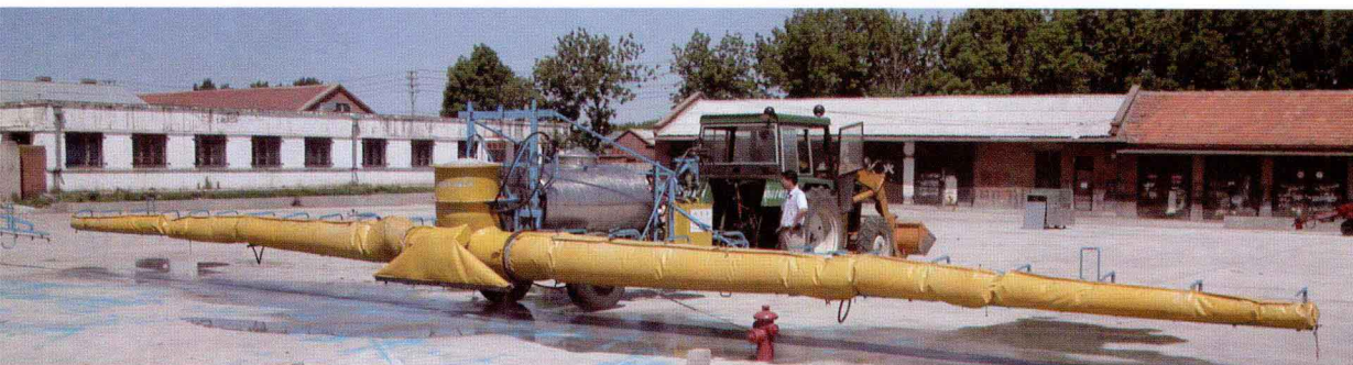
图18 黑龙江研制的大型气流辅助式喷杆喷雾机
