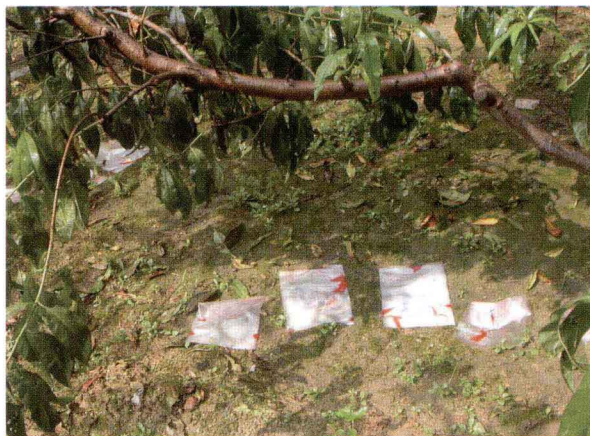
图36 果园大雾滴、大容量喷雾，药液流失严重
