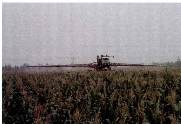
图11 3WZC-2000型超高地隙自走式喷杆喷雾机 (中国农业机械化研究院)
