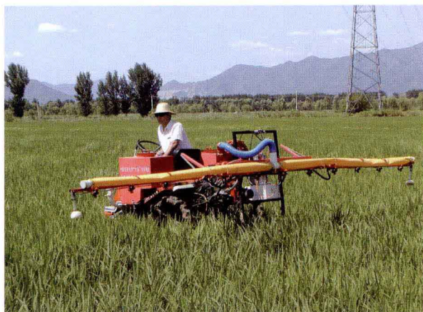
图22 水田气流辅助喷杆喷雾机（中国农业大学）
