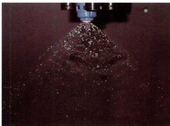
图17 标准扇形雾喷头的工作状态
