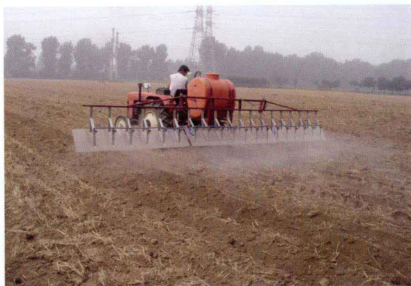
图19 中国农业大学研制的防飘小型喷杆喷雾机（加装防护板）
