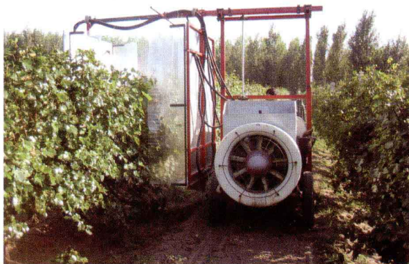
图41 果园循环喷雾机（中国农业大学）
