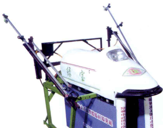
图23 水田用双自走式高地隙喷杆喷雾机 (常州市武进江南植保器械有限公司)
