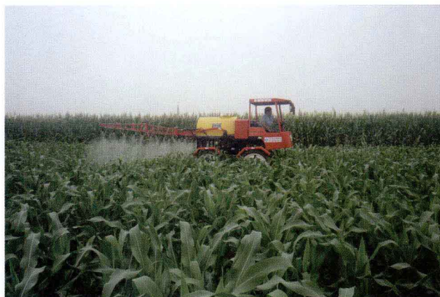
图10 3WZG-650型高地隙自走式喷杆喷雾机在玉米田喷雾 (中国农业机械化研究院)
