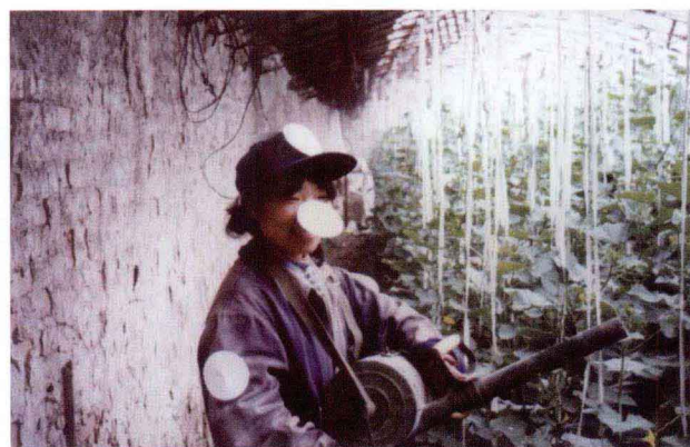
图9 粉尘法施药对操作者污染程度的测定
