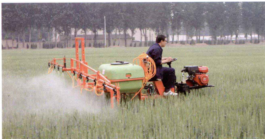
图25 小麦田后期喷杆喷雾（北京丰茂植保机械有限公司）
