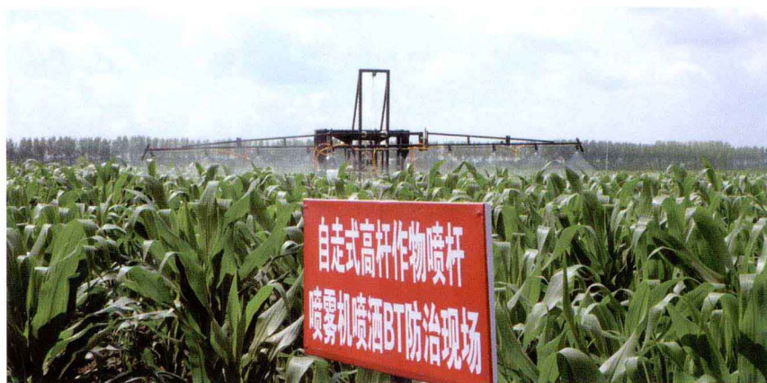
图26 高杆喷雾机在玉米后期喷洒BT防治害虫
