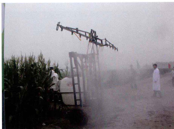
图13 轻便自走式高杆喷雾机在玉米后期喷雾（河南）
