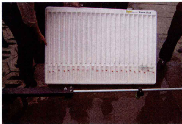
图16 喷杆喷雾机喷雾均匀性测试板
