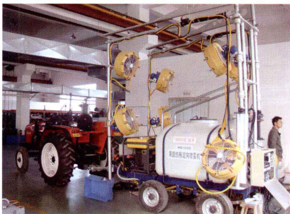
图42 果园仿形定向喷雾机（南京农业机械化研究所）
