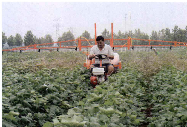
图12 轻便自走式喷杆喷雾机棉田作业(河南)
