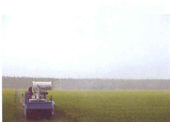
图33 我国开发的风送喷雾机在防治水稻病虫害
