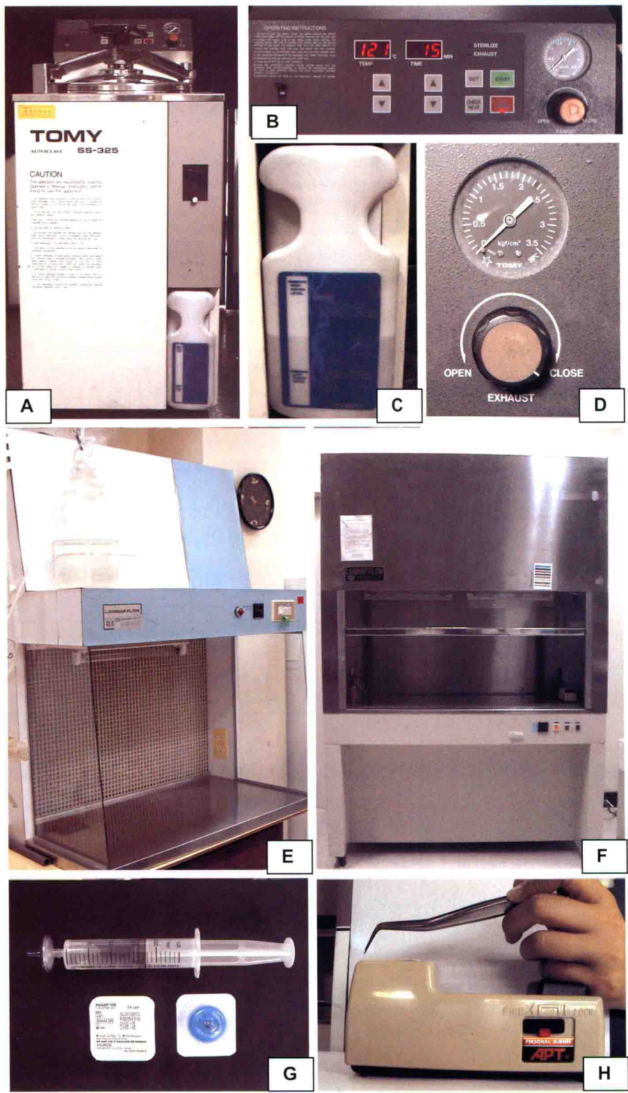
圖 1.1. 植物組織培養無菌操作設備。 A. 高壓蒸汽滅菌釜； B. 高壓蒸汽滅菌釜控制面板； C. 蒸氣水罐內需補充蒸餾水； D. 排氣開關需關閉； E. 水平送風式無菌操作台； F. 垂直送風式無菌操作台； G. 微孔過濾設備； H. 瓦斯槍。
