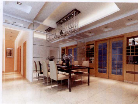
顶面 [ 石膏板造型 + 灯带 ] 墙面 [ 银镜 ]
