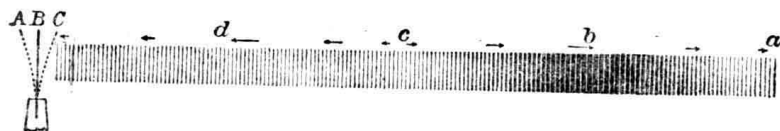
圖 129. 一個完全聲波由疏部與密部合成。圖中顯示各部質點的動向。
