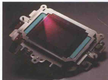
数码单反相机内部的感光元件：CCD
