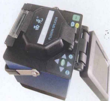
图 11-3 光纤熔接机俯视图
