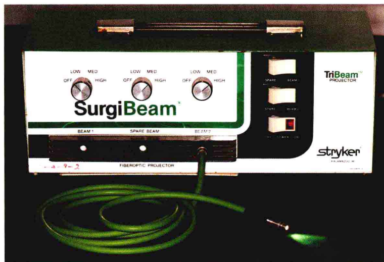
图 1-17 冷光源照明系统
