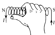
图 11-8 确定载流螺线管极性的右手定则
