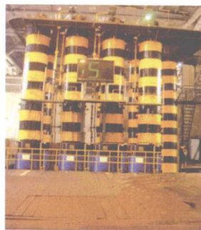
图 1.3.3 锻造液压机的动力系统
