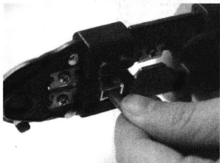
图1-14 将水晶头压紧
