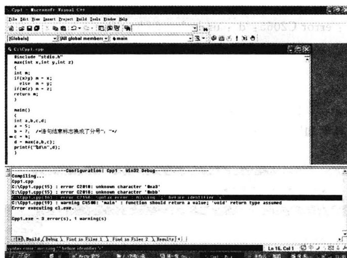
图 1.4 语句结束标志写为分号时的运行界面
