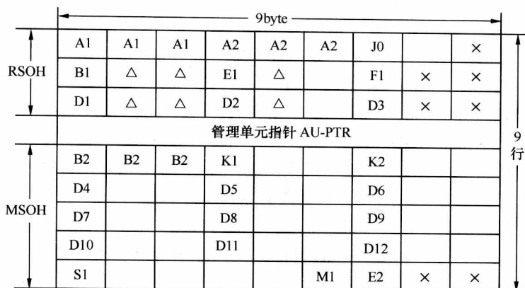
图 1-9 STM-1 段开销的安排
