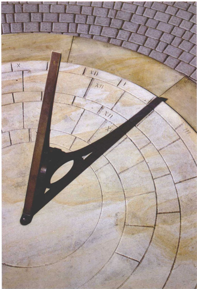
日晷，是以阳光下形成的影子测时的计时仪器，利用了直射光的强烈明暗对比，阴影随着太阳的移动而移动的原理。
