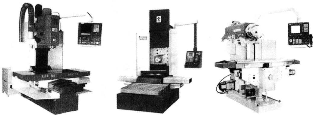
图 1-12 立式、卧式、立卧两用式数控铣床
