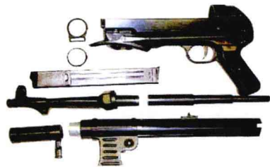
MP 38/40式9毫米 冲锋枪不完全分解图
