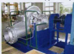
SQN 前置增压泵 Booster Pump
